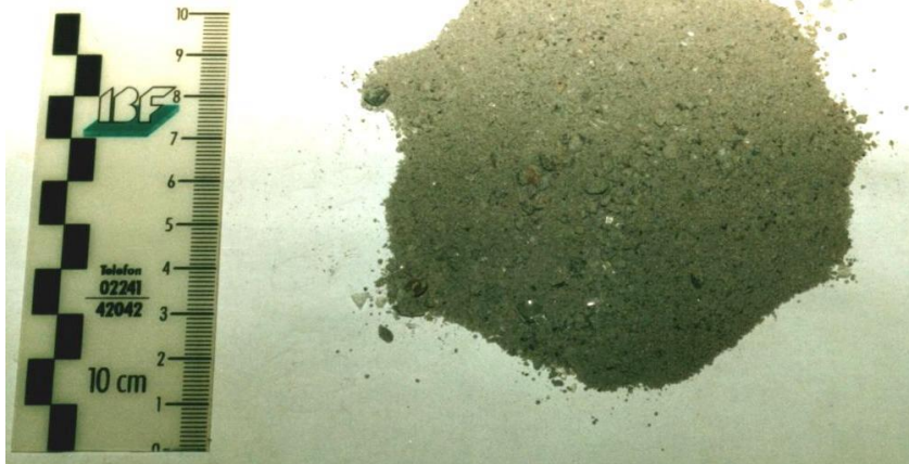
Fein zermahlene Estrichprobe nach 10-minütigem Aufmahlen im Rahmen der gewerbeüblichen CM-Prüfung gemäß dem gewerkübergreifenden Schnittstellenprotokoll
