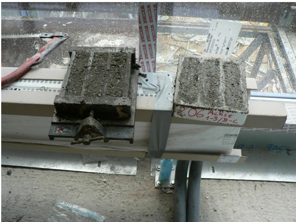
Eigenüberwachung - Güteprüfung eines Zement-Estrichmörtels an Prismen 4 cm x 4 cm x 16 cm (Herstellung der Estrichprismen)
