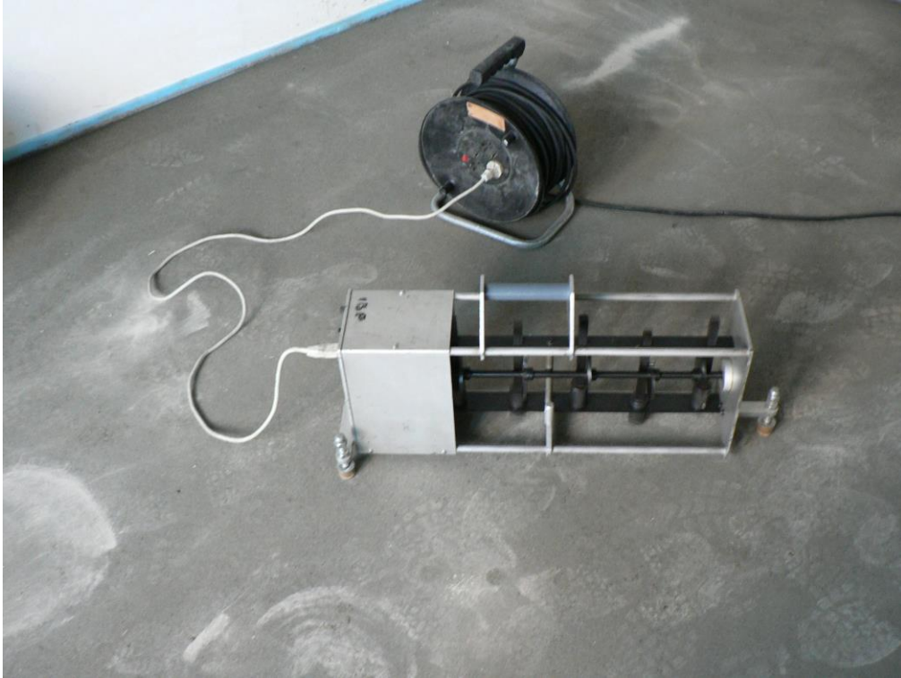
Güteschutz Estrich - Trittschallmessung eines schwimmenden Estrichs mit dem Normhammerwerk im Zuge der Fremdüberwachung
