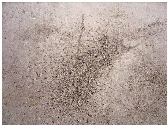
Abb. 2 a+b: Unzureichende Oberflächenfestigkeit bei Zement- und Calciumsulfatestrichen
