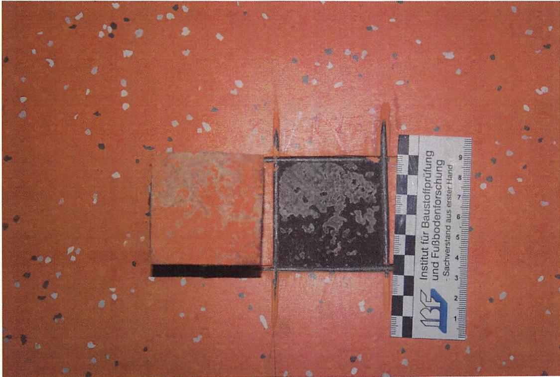
**Bild 26:** Versuchsfläche 1 - Prüfung Haftzugfestigkeit; Abriss im Klebstoff bzw. zwischen Kautschukbelag und Spachtelmasse
