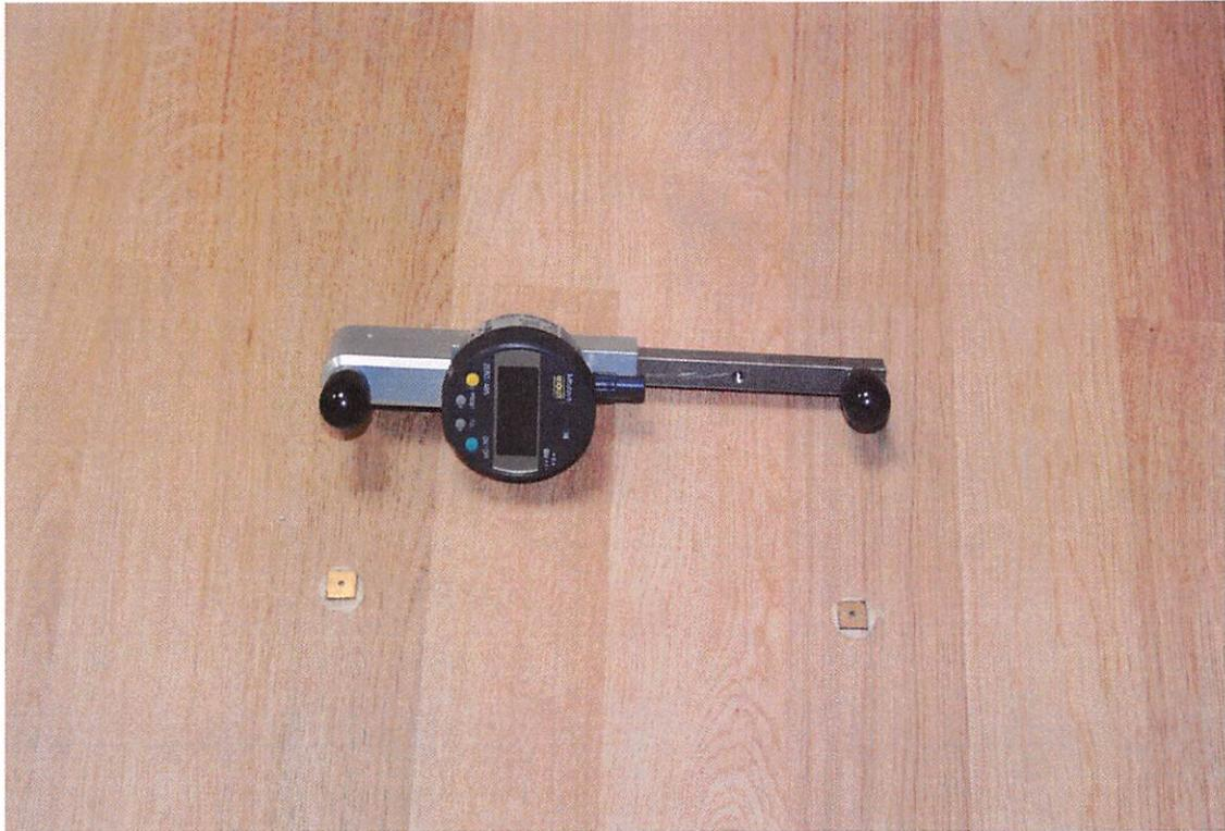
**Bild 17:** Messung der horizontalen Längenänderungen des Parketts mit dem Setzdehnungsmesser
