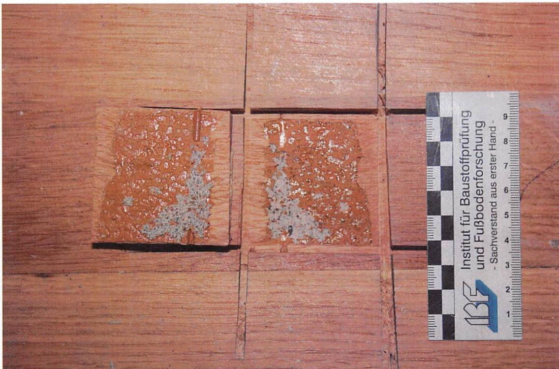
**Bild 31:** Versuchsfläche 4 - Prüfung Haftzugfestigkeit Eicheparkett; Abriss Klebstoff/oberste Estrichrandzone
