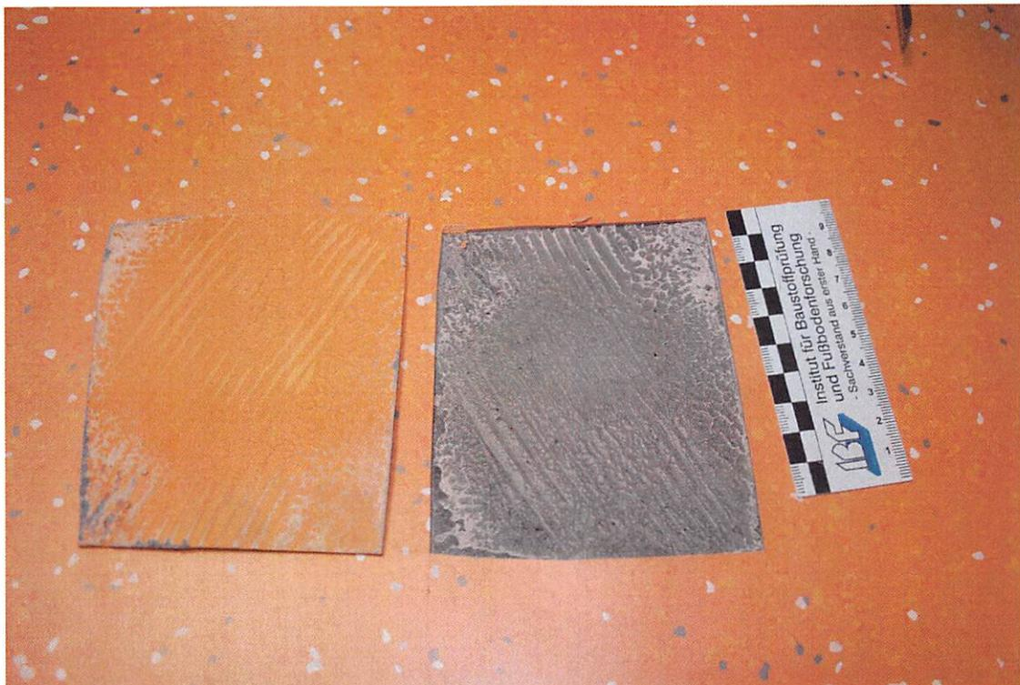
**Bild 21:** Versuchsfäche 1 - Blase vom 06.06.2016 nach dem Öffnen; Ablösung des Kautschukbelags im Klebstoff
