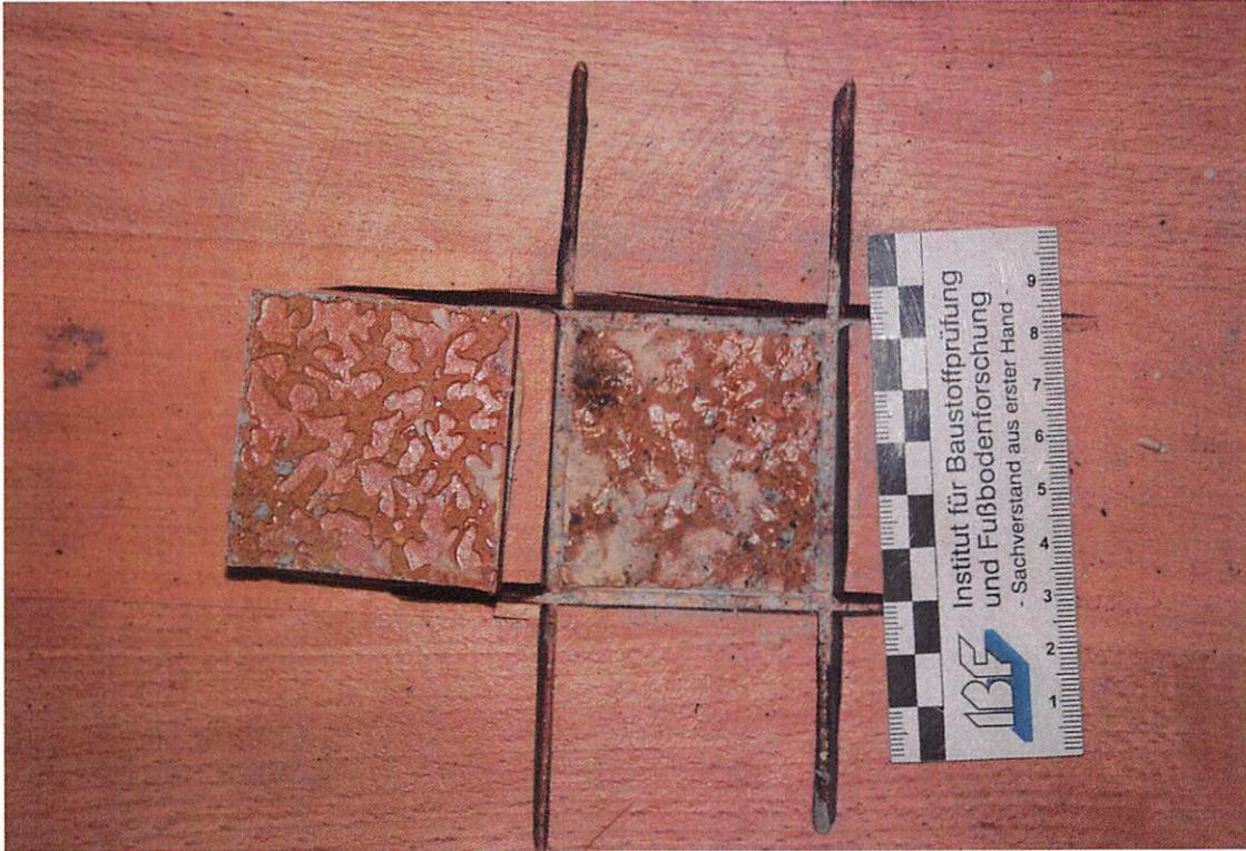
**Bild 28:** Versuchsfläche 2 - Prüfung Haftzugfestigkeit Bucheparkett; Abriss Klebstoff/oberste Estrichrandzone
