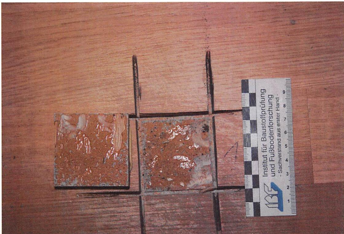
**Bild 29:** Versuchsfläche 2 - Prüfung Haftzugfestigkeit Eicheparkett; Abriss Klebstoff/oberste Estrichrandzone
