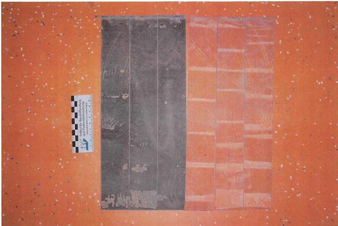
**Bild 25:** Versuchsfläche 3 - Prüfung Schälwiderstand; Abriss zwischen Klebstoff und Spachtelmasse
