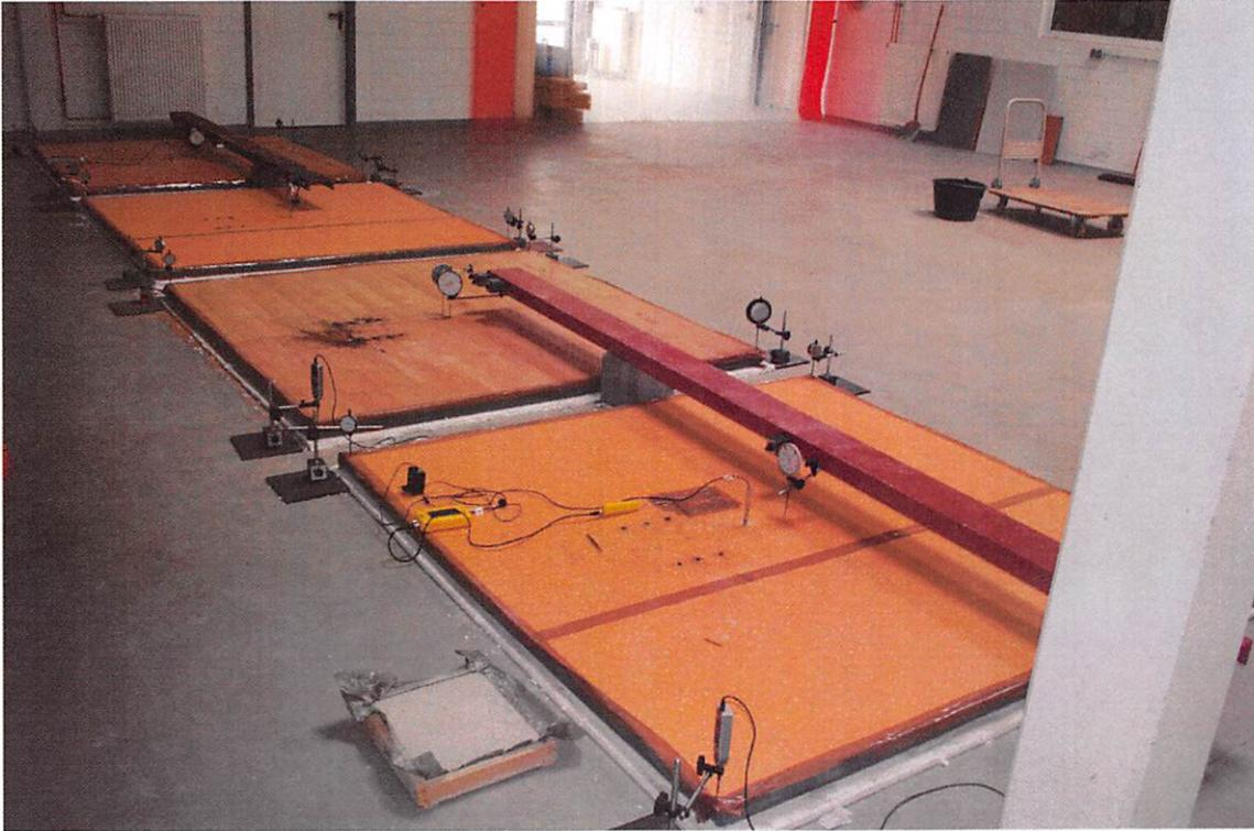
**Bild 13:** Versuchsflächen nach Verlegung der Beläge mit Messvorrichtungen
