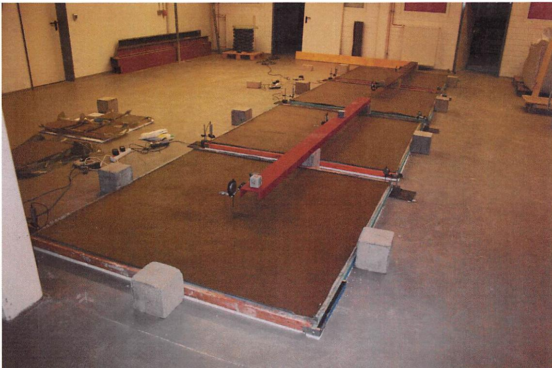
**Bild 2:** Versuchsflächen nach der Verlegung des Zementestrichs mit Messuhren zur Messung der vertikalen Verformungen
