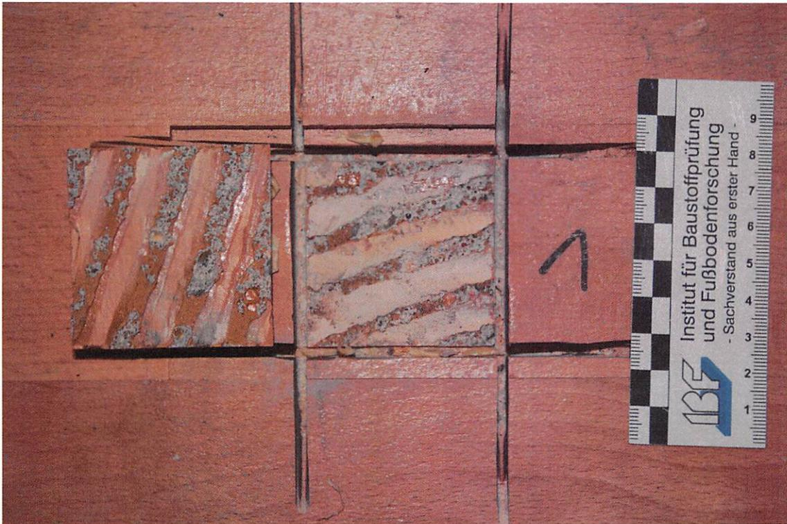
**Bild 30:** Versuchsfläche 4 - Prüfung Haftzugfestigkeit Bucheparkett; Abriss oberste Estrichrandzone
