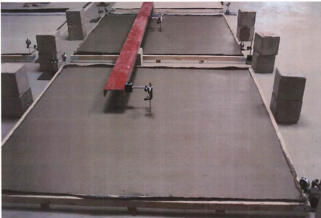
**Bild 79:** Versuchsflächen 2 m x 2 m mit Messuhren für die Verformungsmessungen
