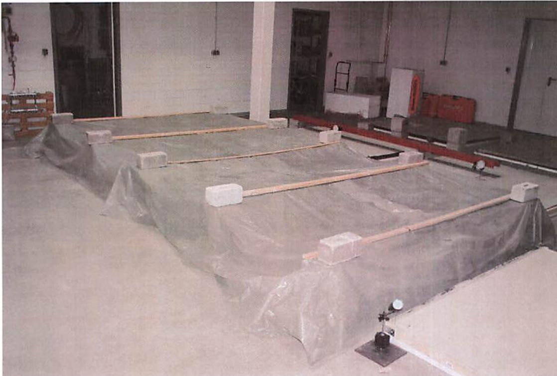
**Bild 78:** Versuchsflächen 2 m x 2 m mit Folieneinhausung (3 Tage Austrocknungsschutz)
