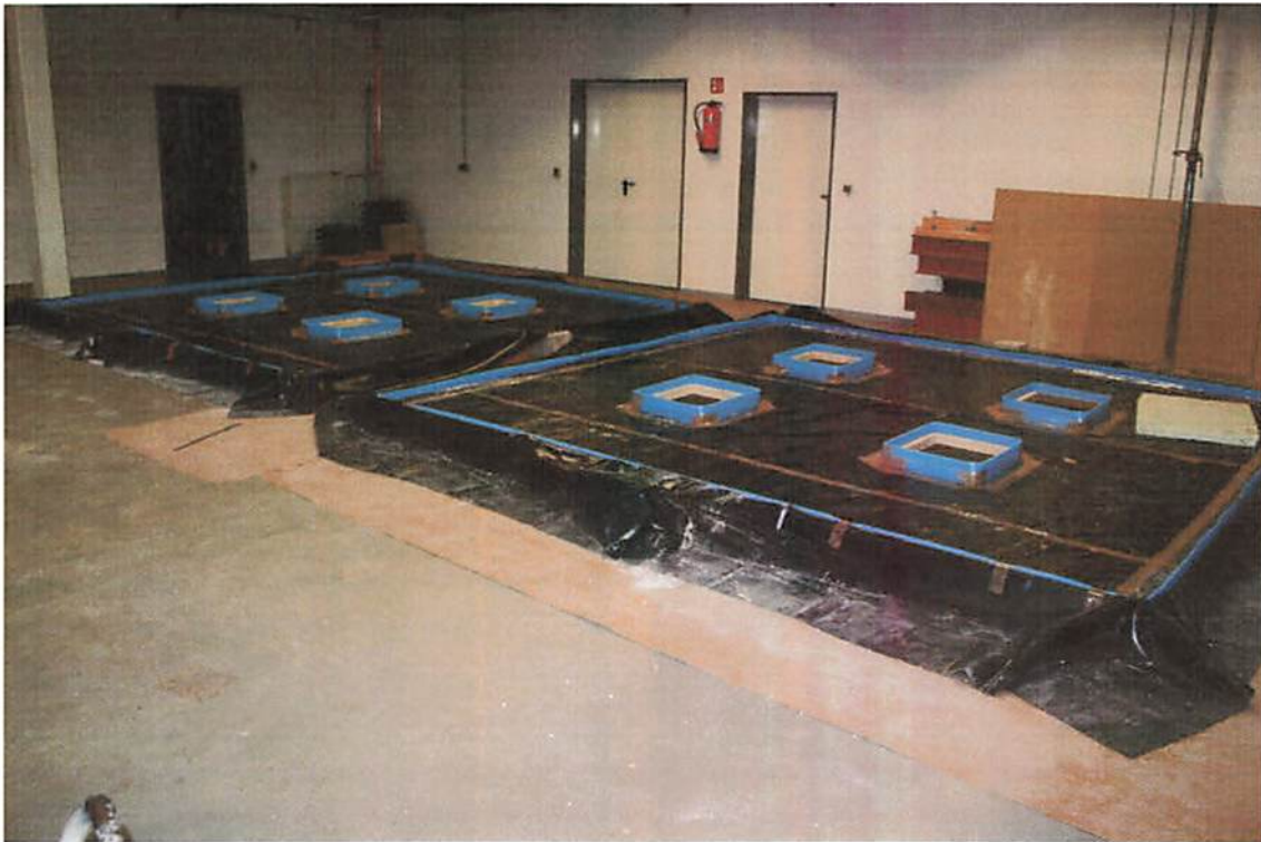
Bild 7: Versuchsflächen vor Einbau des Calciumsulfat-Fließestrichs mit Aussparungen zum späteren Fluten der Versuchsflächen
