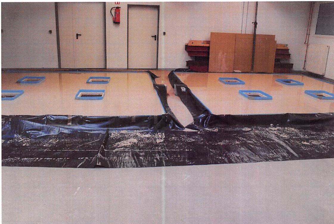
**Bild 10:** Versuchsflächen nach Einbau des Calciumsulfat-Fließestrichs
