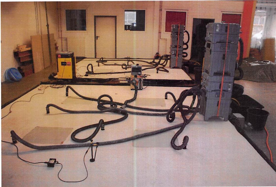
**Bild 13:** Technische Trocknung der Versuchsfächen (Flutöffnungen nach dem Fluten mit Calciumsulfat-Fließestrich verschlossen)
