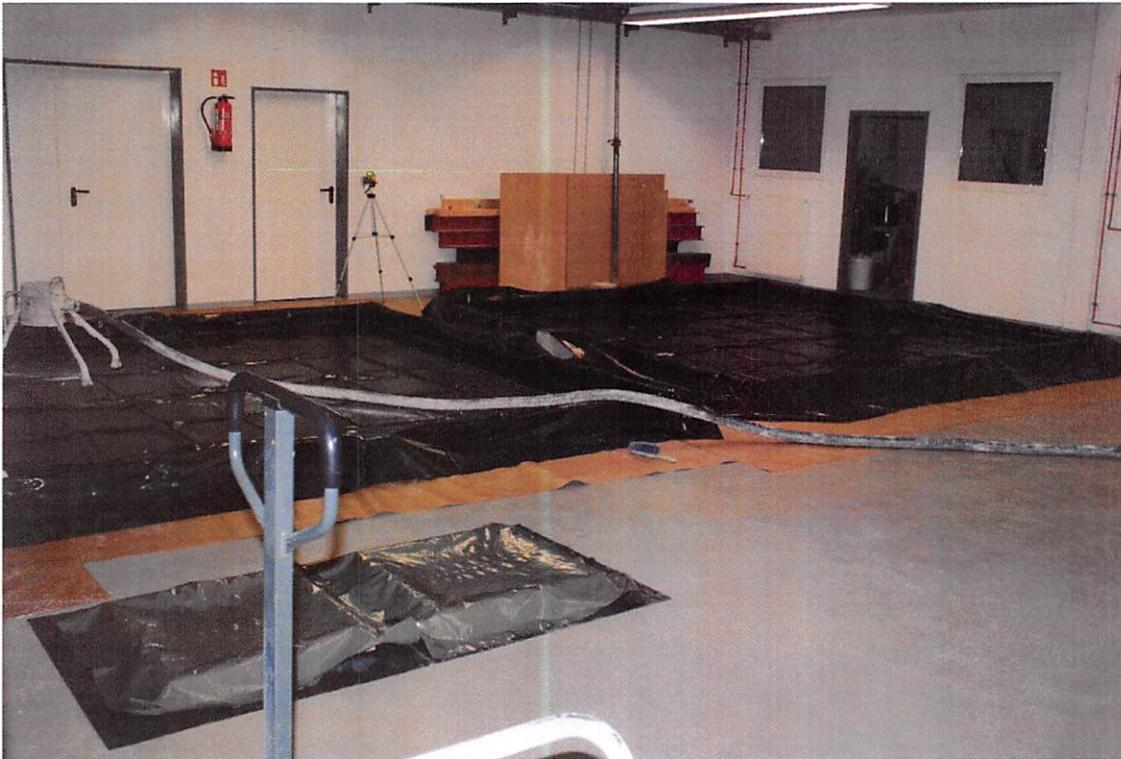
**Bild 1:** Versuchsflächen mit Teichfolie vor Einbau der Leichtausgleichestriche
