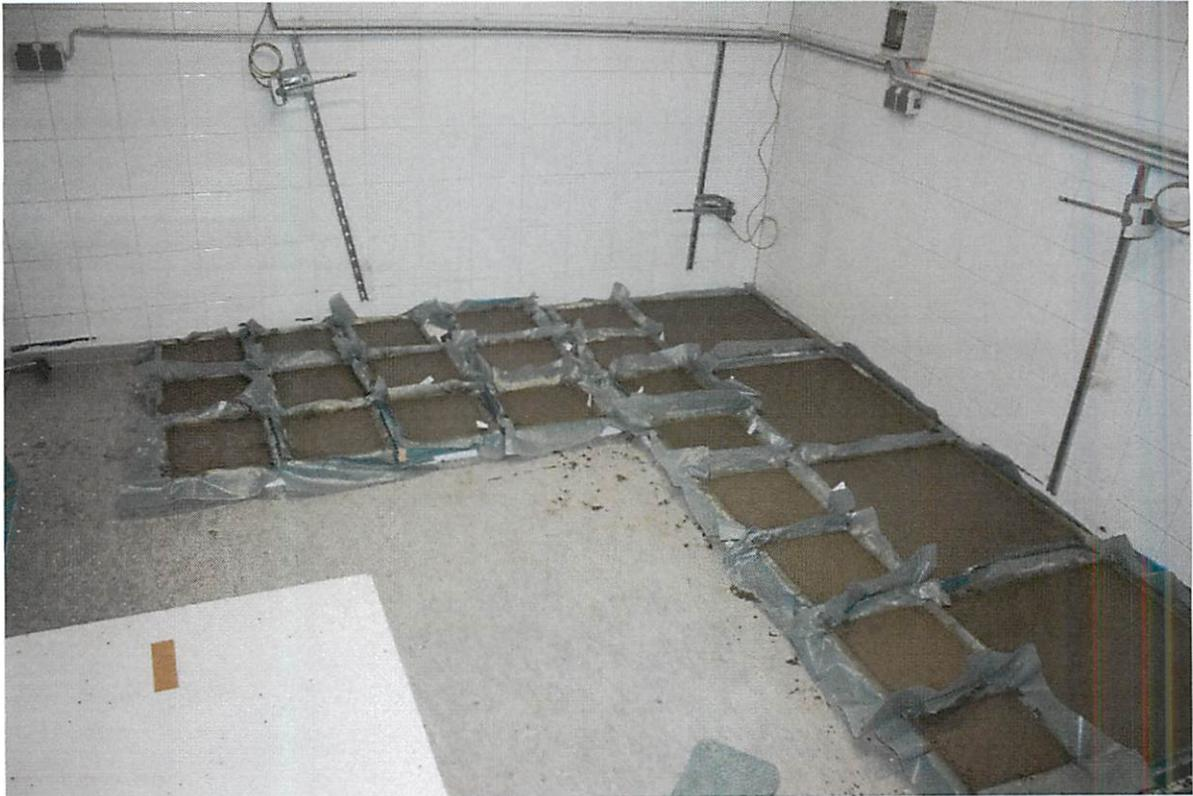
**Bild 1:** Proben für Austrocknungsverlauf und Bestätigungsprüfungen
