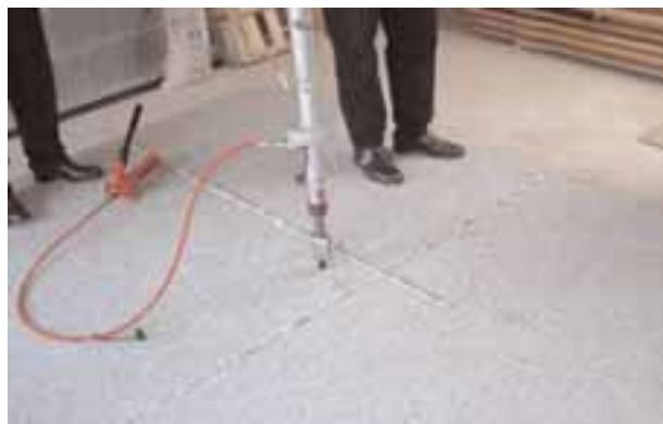
An einer Belagskonstruktion wird hier ein Bauteilversuch durchgeführt, wie er auch für Natursteinbeläge wünschenswert wäre.
