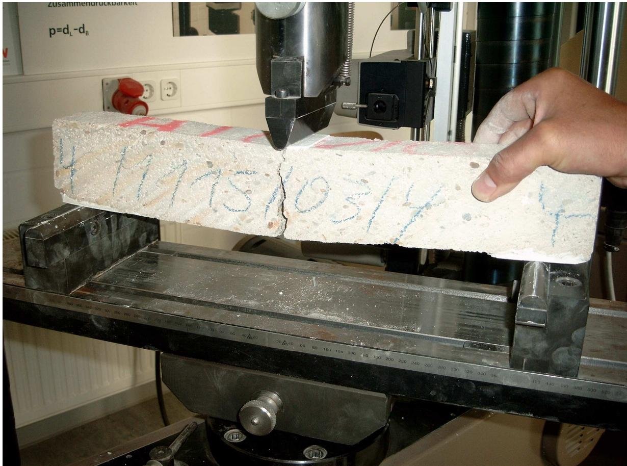
**Bild 4:** Bei der Bestätigungsprüfung zur Ermittlung der Biegezugfestigkeit wird ein Estrichstreifen bis zum Bruch belastet.
