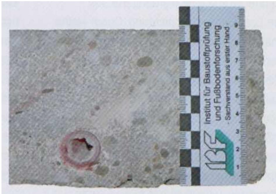
**Bild 2:** Querschnitt eines Heizestrichs Bauart A;
