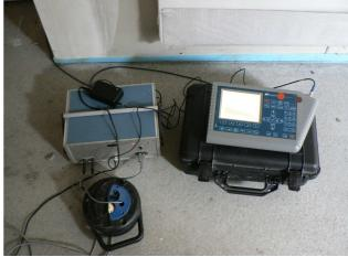
Eine normgerechte Trittschallmessung wird mit Hammerwerk und Schallpegelmesser durchgeführt.
