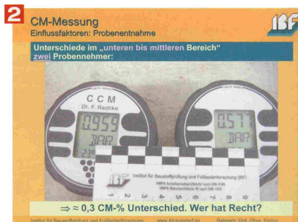
Bild 2: Vergleich der Probenentnahme aus unterem bis mittlerem Bereich
