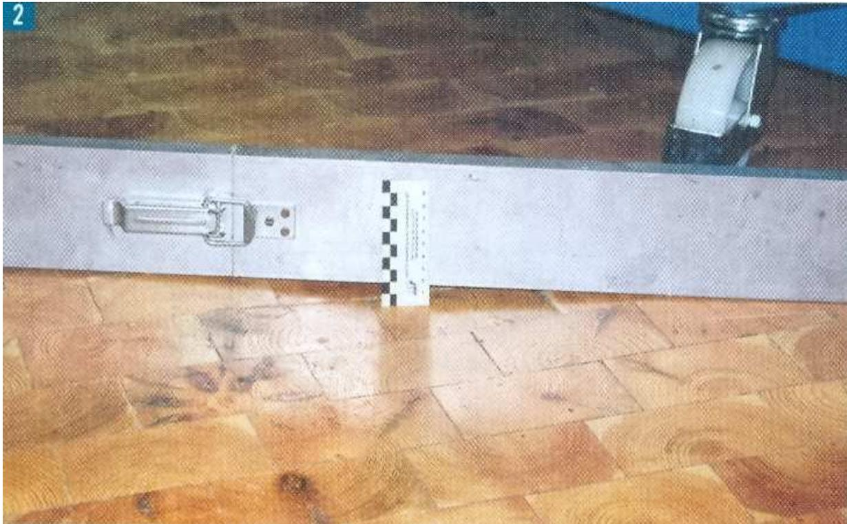
**Bild 2:** Diese Eindrücke wurden in einem Papierlager auf einem auf Gussasphaltestrich verlegten Holzpflaster festgestellt.
