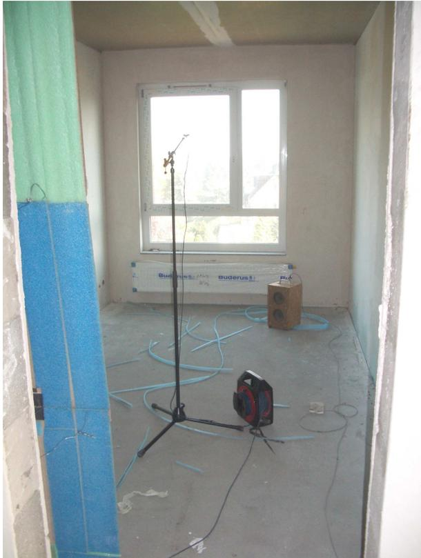
**Bild 3:** Messeinrichtung im Empfangsraum
