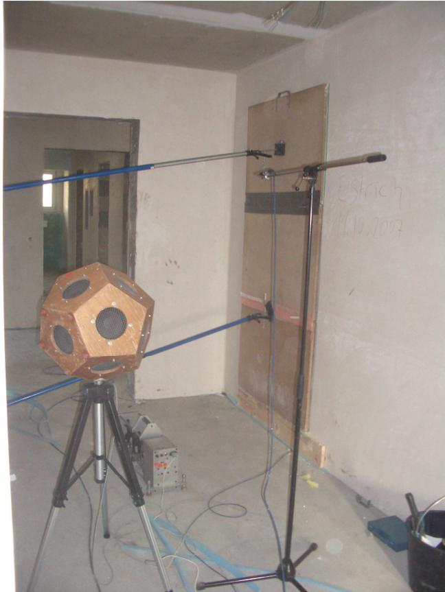
**Bild 2:** Messeinrichtung im Senderaum (Flur) und abgesperrter Türdurchgang während der Messung
