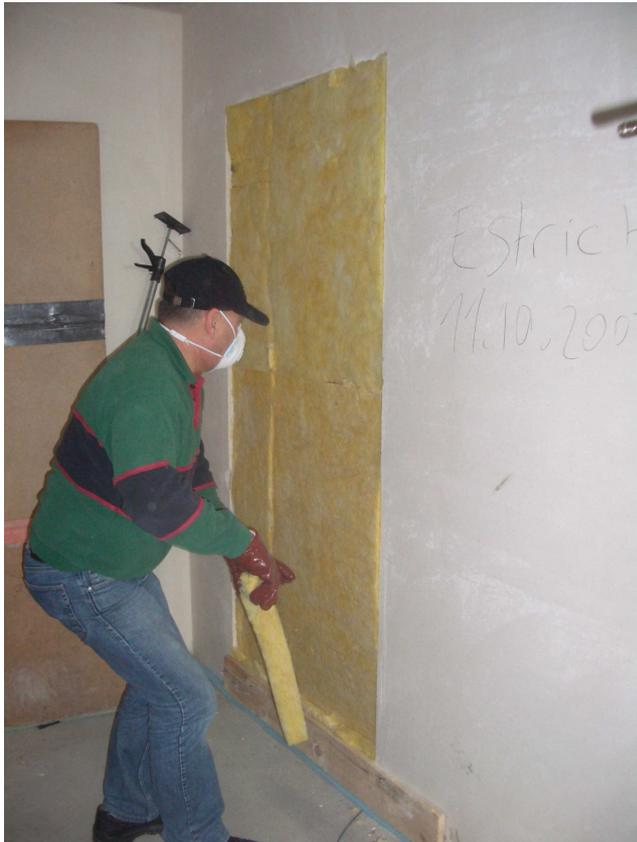
**Bild 1:** Absperren des Türrdurchganges vor der Schallmessung
